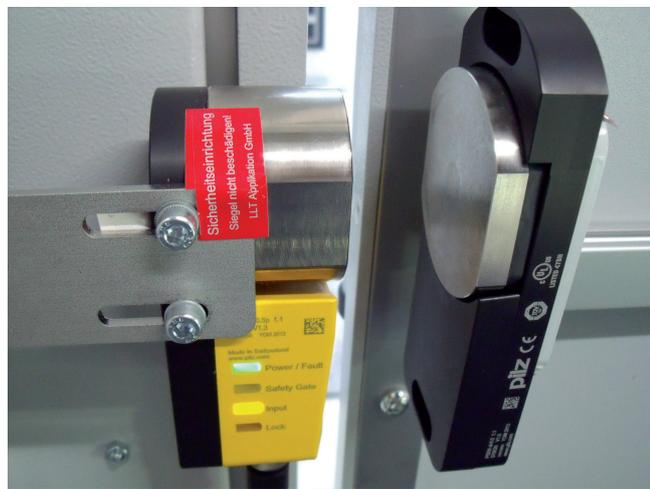
**Bild 2.** Elektromagnetische Türzuhaltung in Kombination mit Sicherheitsschaltern erfüllt die Anforderungen an die funktionale Sicherheit („Performance-Level“).
