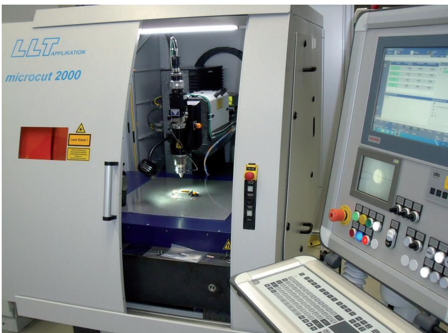
**Bild 1.** Moderne Laseranlage zur Mikrobearbeitung mit frequenzverdoppeltem Faserlaser und elektrischer Sicherheitssteuerung für Tür und Not-Halt, die dem Stand der Technik entspricht und aktuelle Normvorgaben erfüllt [1].
