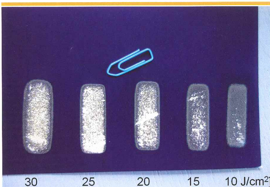
Bild 6: Untersuchung (qualitativ) der Energiedichteverteilung über den Strahlquerschnitt durch Einbrände auf photoempfindlichem Papier. Unterschiedliche Energiedichten im Bereich 10–30 J/cm²; je 1 Puls 14ms
