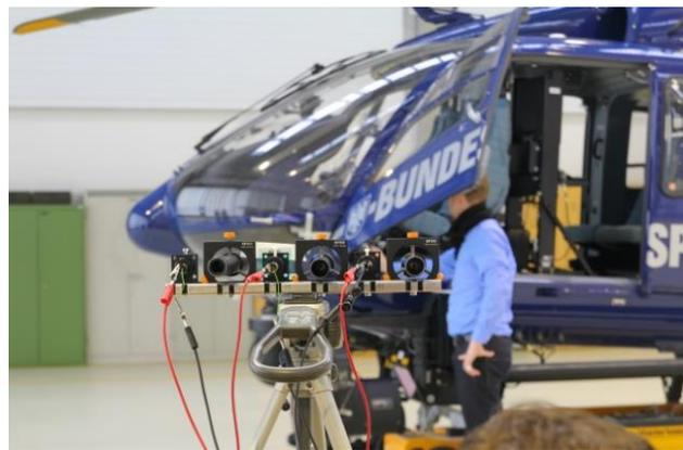
**Abb. 44:** EC 135 Polizei-Helikopter bei der Bundespolizei-Fliegerstaffel in Fuhlendorf. Links: durch Bodenfenster (rote Pfeile) kann Laserpointerstrahlung ungehindert in das Cockpit gelangen; rechts: Versuchsaufbau mit verschiedenen Laserpointern vor dem Cockpit.
