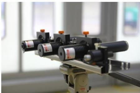
**Abb. 49:** Laserpointerhalterung auf Stativ zur Durchführung der Leistungsmessungen
