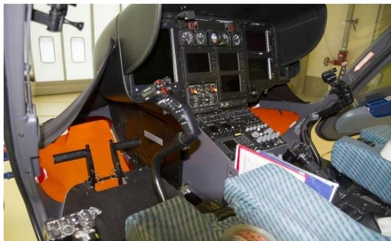
**Abb. 54:** Cockpit eines EC 135 mit eingesetzten Filterfolien Typ 158 (links) und Typ 779 (rechts).
