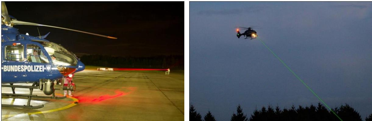
**Abb. 53:** Feldversuche mit gezielter Laserpointerbestrahlung unter realen Bedingungen (links: am Boden, rechts: während des Fluges).
