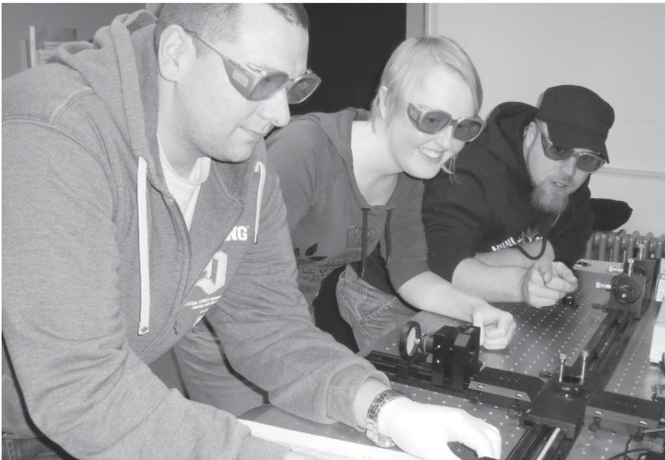
Abb. 4: Das Tragen von Laserschutzbrillen ist obligatorisch, wenn technische und organisatorische Schutzmaßnahmen alleine nicht ausreichend sind.
