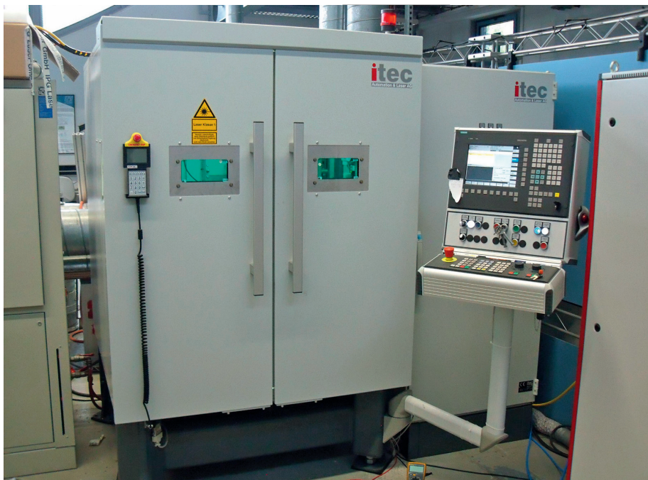
Bild 1: Vollständige Einhausung eines Hochleistungslasers der Klasse 4 kann in Kombination mit weiteren technischen Schutzmaßnahmen zur Laserklasse 1 der gesamten Lasereinrichtung führen
